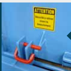
Bloqueo de seguridad del basculamiento
