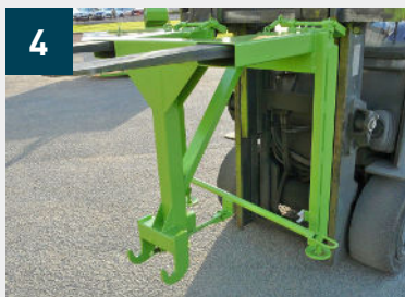
Enganche del pescante PK en la carretilla elevadora
