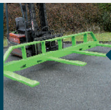
Versión con 4 horquillas ajustables
