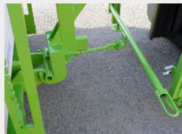
Agarre de la carretilla MP con el pescante - Palanca con clip para bloquear automáticamente el gancho en la carretilla MP sin intervención del operador de la carretilla
