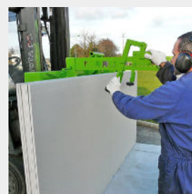
Cargamento facilitado simplemente deslizando las placas hacia la derecha Después de distribuirlas, recolocar el brazo de ajuste para mantener las placas restantes
