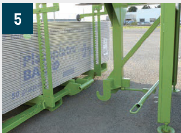
Agarre de la carretilla MP con el pescante - Palanca con clip para bloquear automáticamente el gancho en la carretilla MP sin intervención del operador de la carretilla
