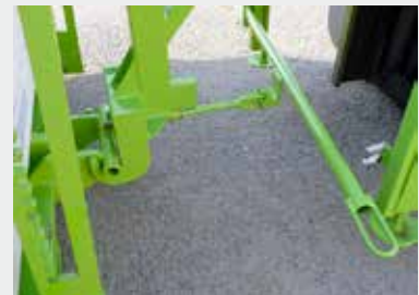
Agarre de la carretilla MP con el pescante - Palanca con clip para bloquear automáticamente el gancho en la carretilla MP sin intervención del operador de la carretilla
