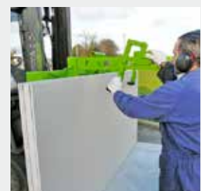
Cargamento facilitado simplemente deslizando las placas hacia la derecha Después de distribuirlas, recolocar el brazo de ajuste para mantener las placas restantes
