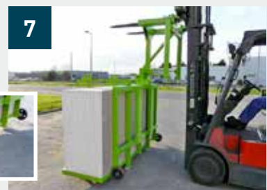
Carretilla en posición de descarga antes de retirar el pescante PK
