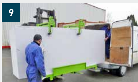
Cargamento facilitado simplemente deslizando las placas hacia la derecha Después de distribuirlas, recolocar el brazo de ajuste para mantener las placas restantes
