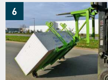
Volteo de la carretilla en vertical, 4 patines PEHD que evitan dejar marca en el suelo
