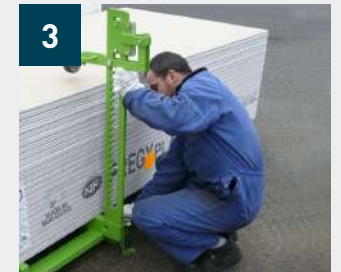
Posición de los brazos de retención regulable
