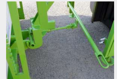
Agarre de la carretilla MP con el pescante - Palanca con clip para bloquear automáticamente el gancho en la carretilla MP sin intervención del operador de la carretilla
