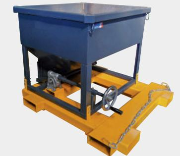
Guillotina de regulación de flujos por reductor de ángulo
