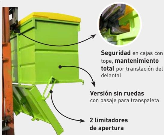
**Seguridad** en cajas con tope, **mantenimiento total** por translación del delantal
