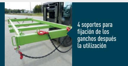
4 soportes para fijación de los ganchos después la utilización
