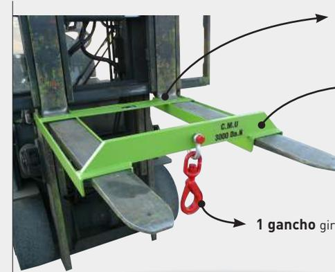
Bloqueo automático sobre talones de horquillas
