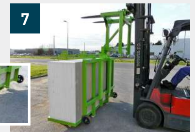
Carretilla en posición de descarga antes de retirar el pescante PK
