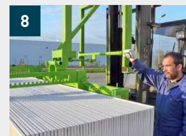
Cierre en clip de la palanca que permite desenganchar y retirar el pescante PK
