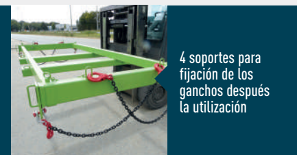
Cadena de elevación con gancho de seguridad y anillo acortador
