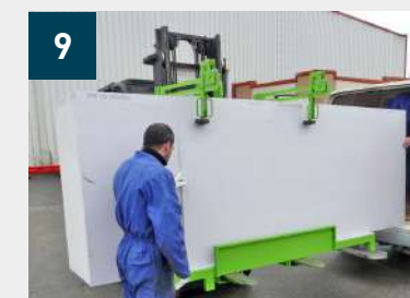
Cargamento facilitado simplemente deslizando las placas hacia la derecha. Después de distribuirlas, recolocar el brazo de ajuste para mantener las placas restantes
