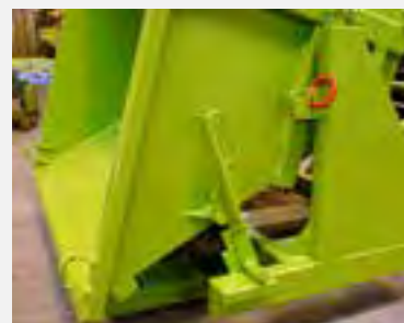
Bloqueo en posición basculada (BBP)
