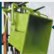
Vaciado con PL estándar toma superior
