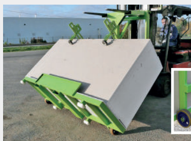
6 Volteo de la carretilla en vertical, 4 patines PEHD que evitan dejar marca en el suelo
