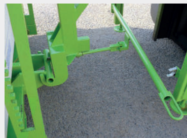
5 Agarre de la carretilla MP con el pescante - Palanca con clip para bloquear automáticamente el gancho en la carretilla MP sin intervención del operador de la carretilla
