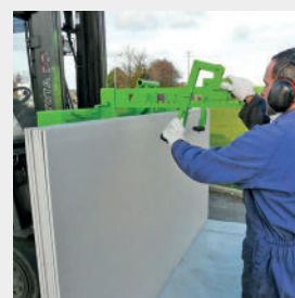
9 Cargamento facilitado simplemente deslizando las placas hacia la derecha Después de distribuirlas, recolocar el brazo de ajuste para mantener las placas restantes
