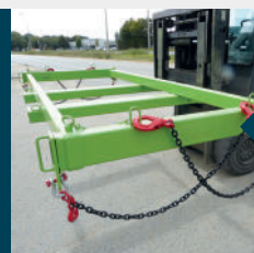
Cadena de elevación con gancho de seguridad y anillo acortador
