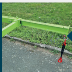
Cadena de elevación con gancho de seguridad y anillo acortador
